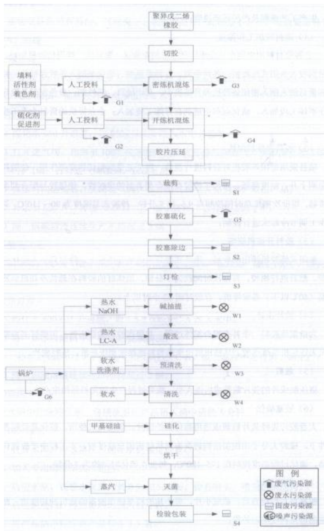
图 3.4 项目生产工艺流程及产污节点图
