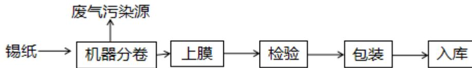
图 2.8.4 锡纸分卷工艺及产排污节点图
