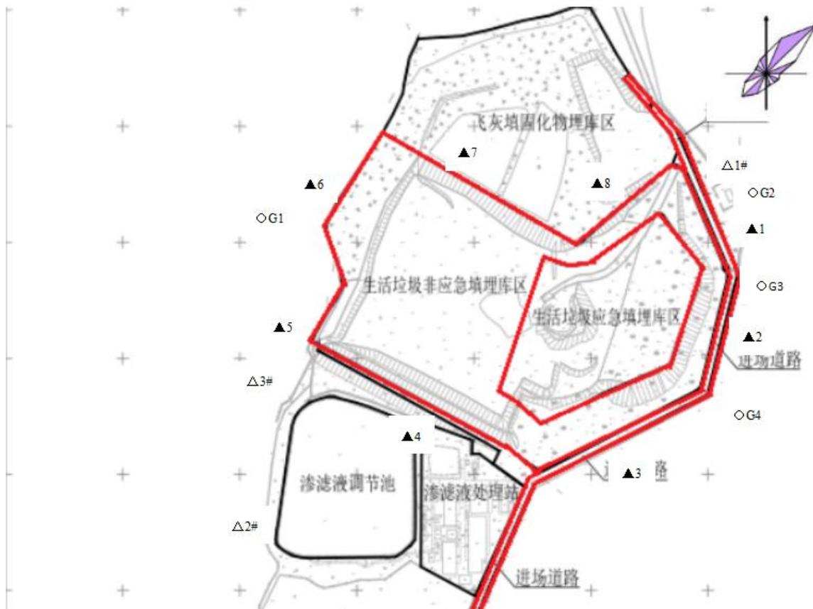
○—无组织废气检测点位；▲—噪声检测点位；△—地下水检测点位；
