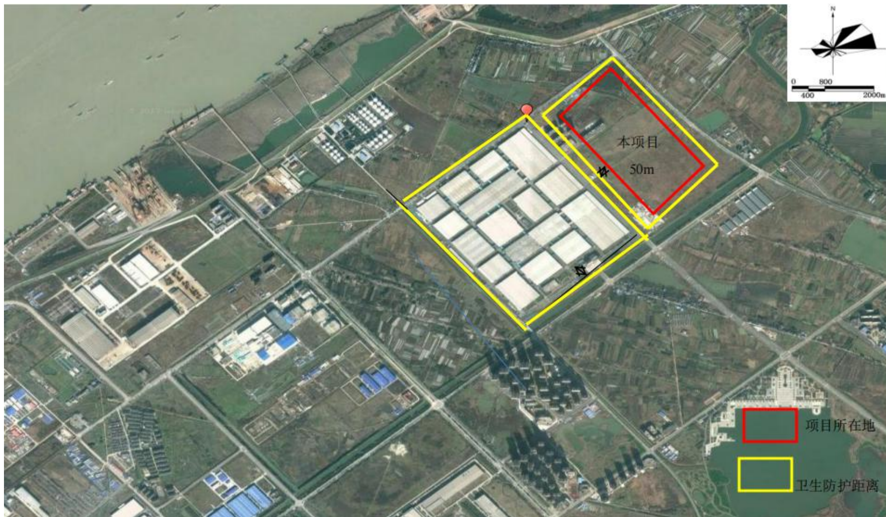
附图3 项目卫生防护距离包络线图
