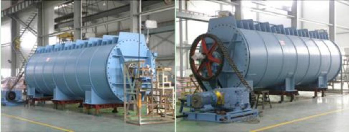
图 3.2-2 圆盘干化机外观图
