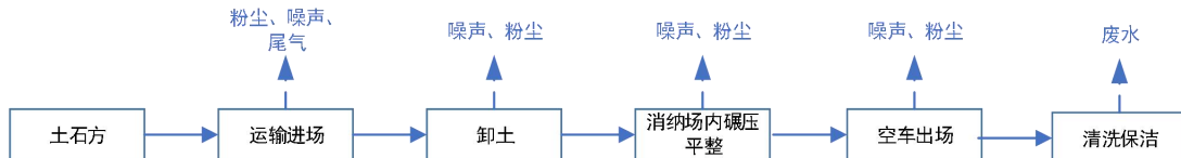
图 2.7-1 项目工艺及产污流程图
