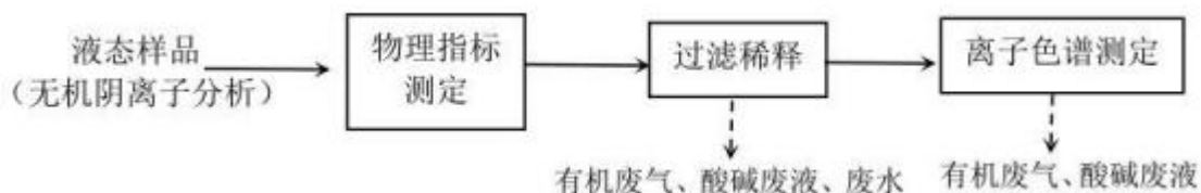
图2-7 液态样品无机阴离子分析工艺流程及产污环节
