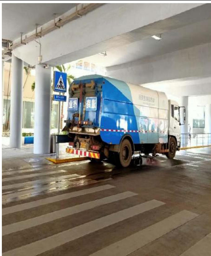
回用中水洒水降尘
