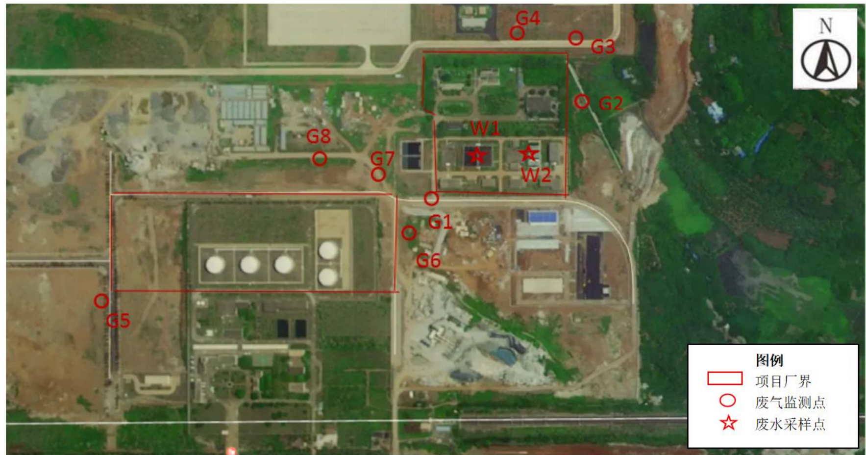
图 7.2-2 废气、废水监测点位分布图
