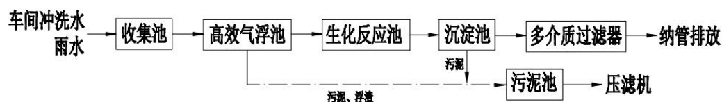
图 4-1 初期雨水处理设施工艺流程图
