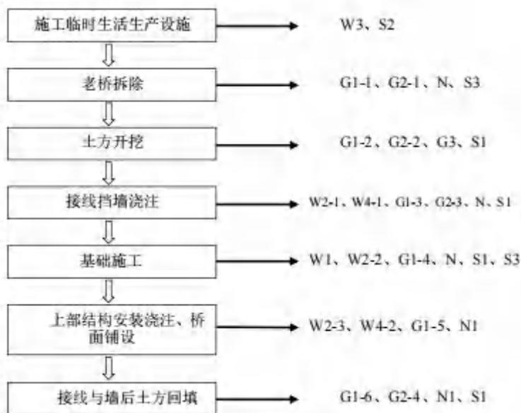
图 4-4 桥梁工程施工工序图
