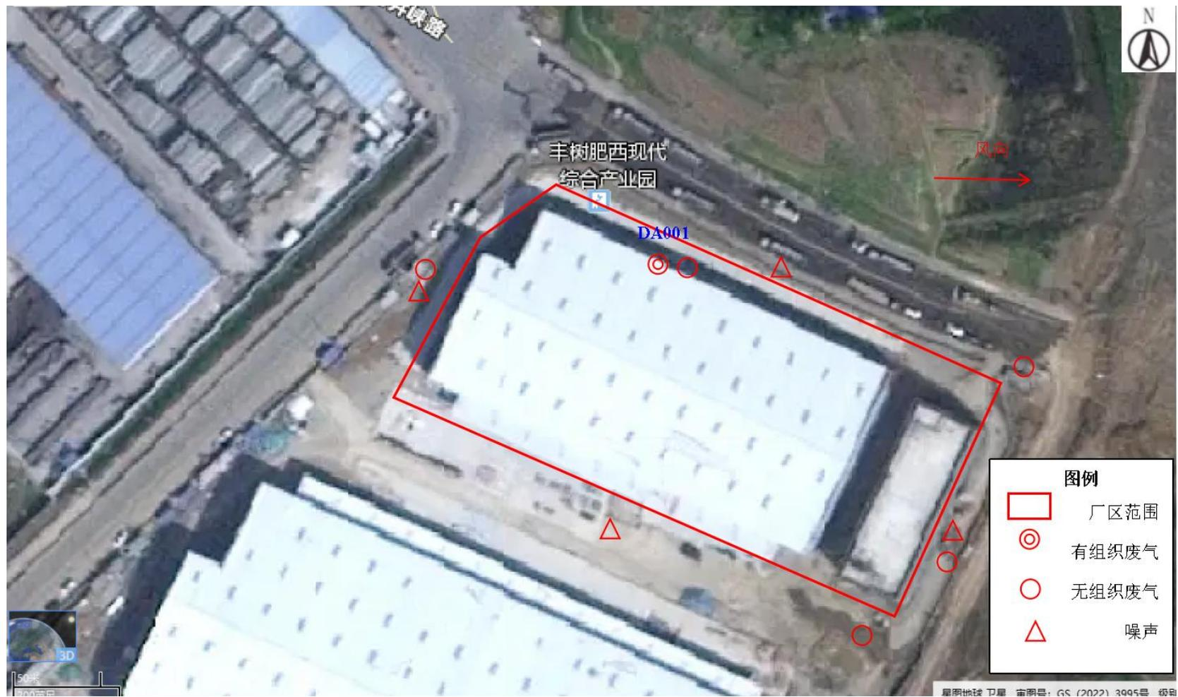
图 5.1 项目污染物现场监测布点简图（5月6日）
