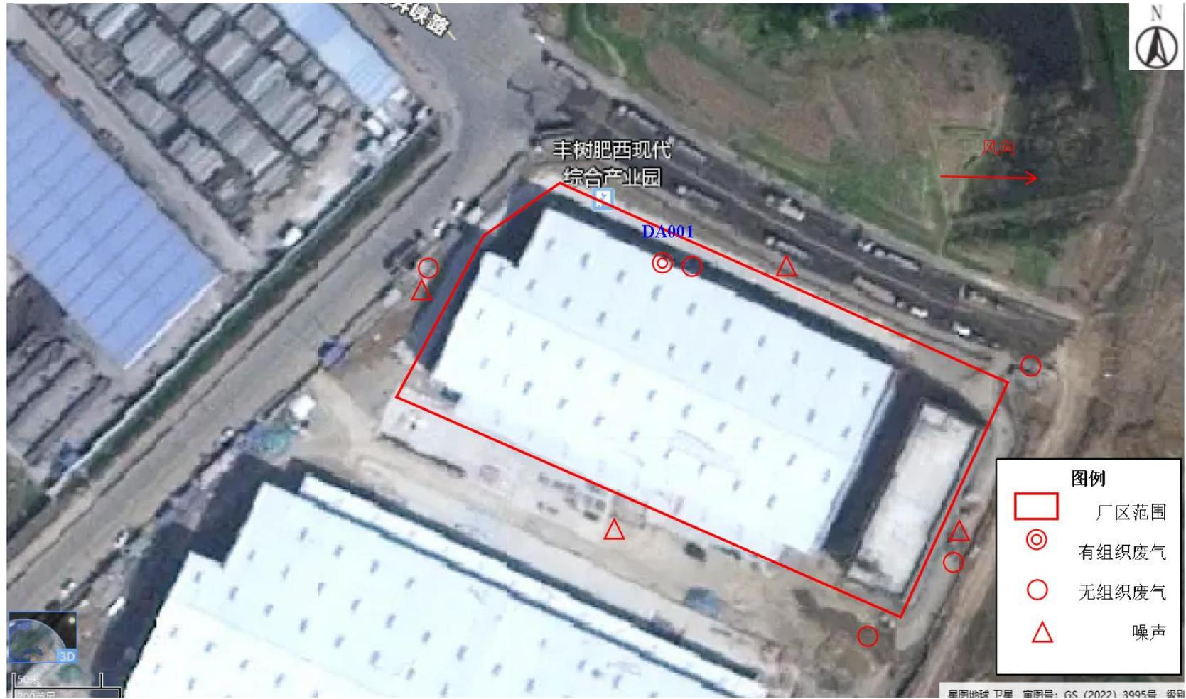
图 5.2 项目污染物现场监测布点简图（5月7日）
